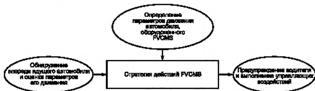
Рисунок 1 — Функциональные элементы системы снижения тяжести последствий от столкновения с движущимся впереди транспортным средством (FVCMS)
