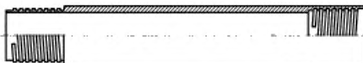
Рисунок С.9 — Обсадная труба водной скважины для соединений встык заподлицо согласно BS 879
