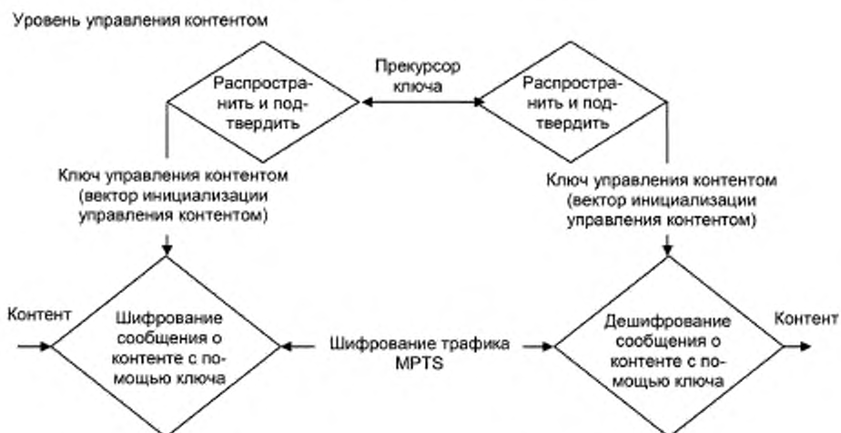
Рисунок 5 — Схема процесса формирования ключей уровня управления контентом
