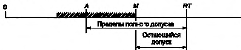
Рис. 5 — Принцип измерения декодируемости
