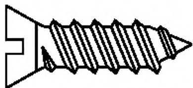
Рисунок 1 — Самонарезающий формирующий винт
