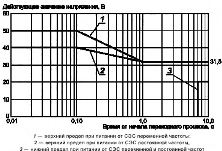
Рисунок 12 — Пределы приведенных значений ненормальных повышенных и пониженных напряжений вторичных систем постоянного тока 27 В
