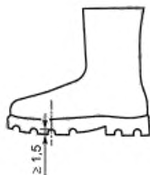
Рисунок В.1 — Трещины на подошве
