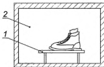
1 — медная пластина (см. 5.13.1.5), 2 — термоконтейнер
