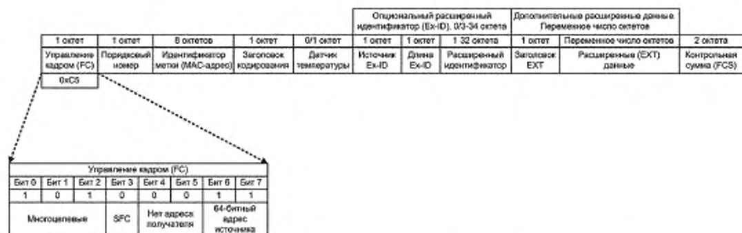
Рисунок 19 — Кодирование кадра блинк-посылки с идентификатором по [18]
