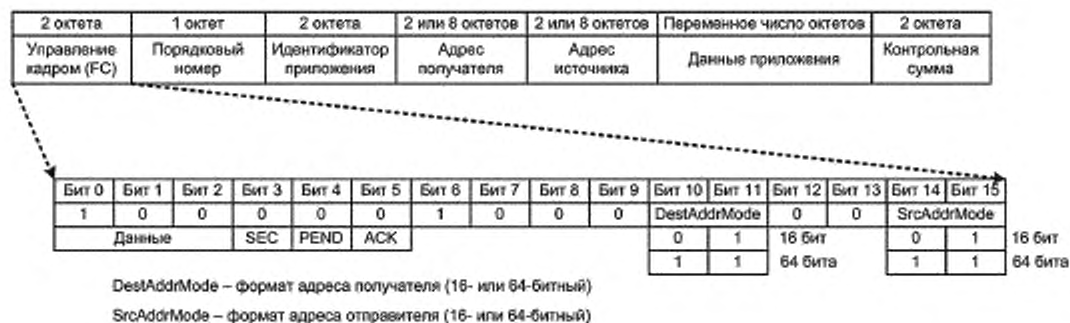
Рисунок 21 — Кодирование кадра данных
