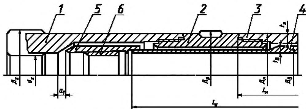
1 – коронка; 2 – расширитель; 3 – наружная колонковая труба; 4 – внутренняя керноприемная труба; 5 – корпус керноприемателя; 6 – керноприемное кольцо
