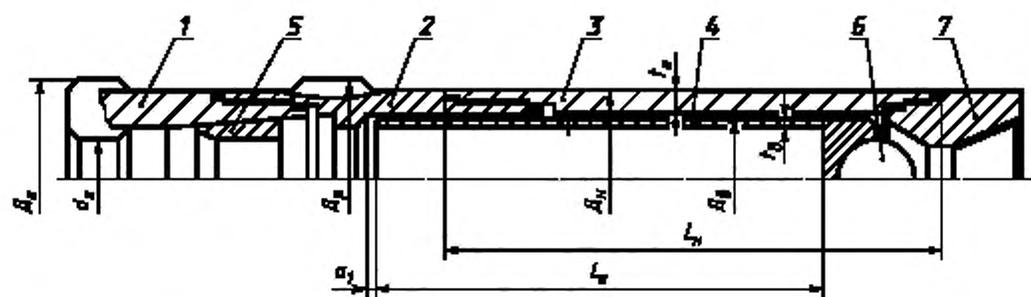
1 — коронка, 2 — расширитель, 3 — наружная колонковая труба; 4 — внутренняя керноприемная труба;
