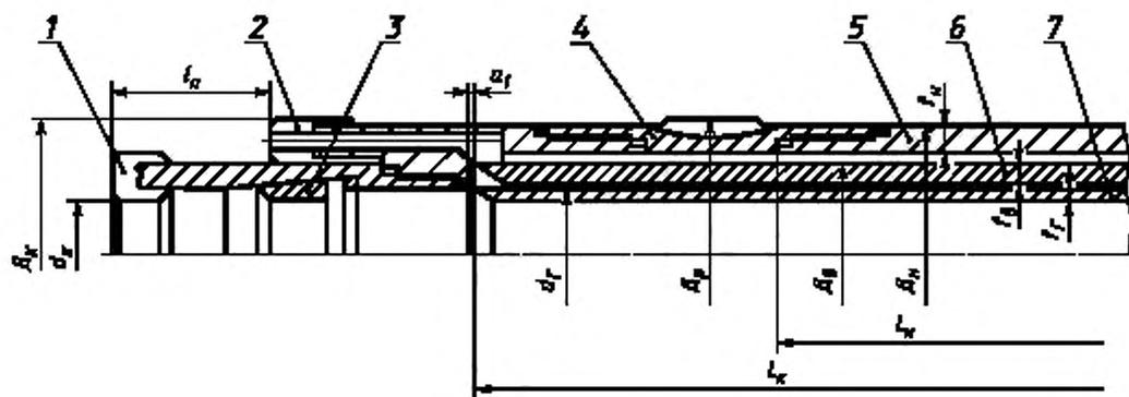
1 – пилот-коронка; 2 – формирующая коронка; 3 – kernорвальное кольцо; 4 – расширитель; 5 – наружная колонковая труба; 6 – внутренняя керноприемная труба; 7 – керноприемная гильза
