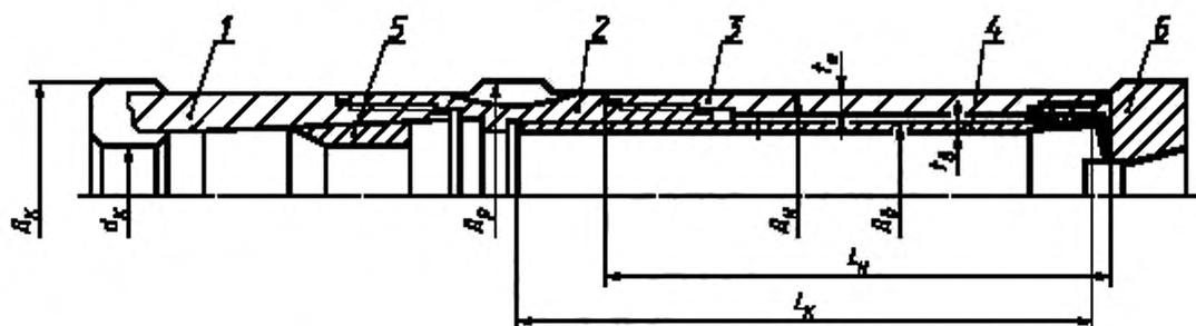
1 — коронка; 2 — расширитель; 3 — наружная колонковая труба; 4 — внутренняя керноприемная труба;
