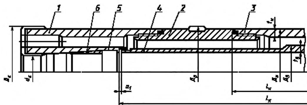
1 – коронка; 2 – расширитель; 3 – наружная колонковая труба; 4 – внутренняя керноприемная труба; 5 – корпус кернорвателя; 6 – кернорвальное кольцо
