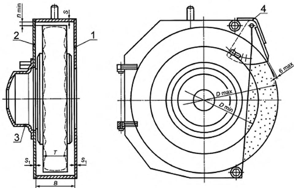
1 — корпус кожуха; 2 — крышка кожуха;
