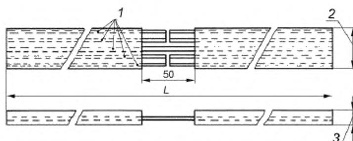
1 — корды; 2 — ширина образца; 3 — толщина образца; L — длина образца
