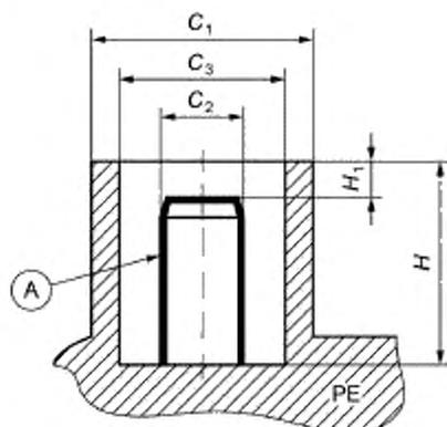
A — рабочая часть,  $C_1$  — наружный диаметр защитной втулки,  $C_1 = 13,00 \pm 0,5$ ;  $C_2$  — диаметр рабочей части клеммы,  $C_2 = 4,70 \pm 0,1$ ;  $C_3$  — внутренний диаметр защитной втулки,  $C_3 = 10,0 - 0,1/+0,5$ ;  $H$  — внутренняя глубина защитной втулки,  $H \geq 15,5$ ;  $H_1$  — расстояние между торцом защитной втулки и рабочей частью клеммы,  $H_1 = 4,5 \pm 0,5$
