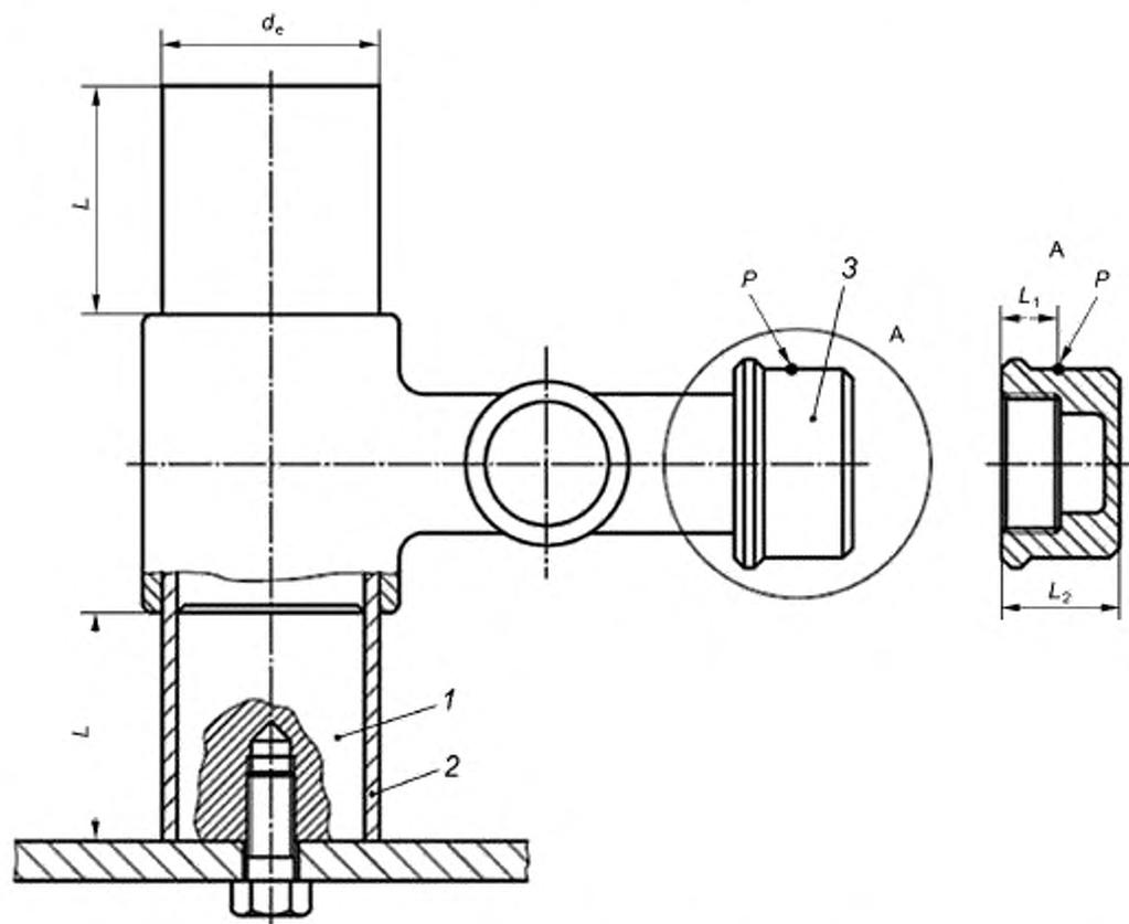
1 — стальной сердечник; 2 — труба; 3 — крышка седлового отвода,  $L = d_c$ ,  $L_1 = L_2/2$ ; P — место нанесения удара
