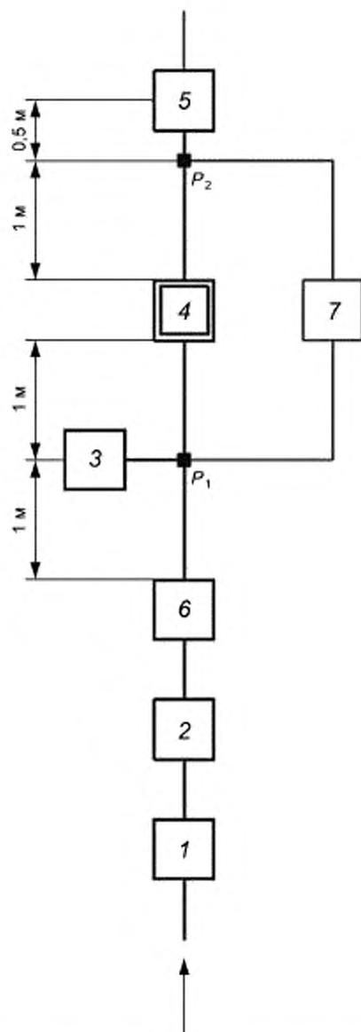
1 — регулятор давления; 2 — расходомер; 3 — манометр; 4 — испытуемый компонент; 5 — выпускной вентиль, 6 — резервуар; 7 — дифференциальный манометр
