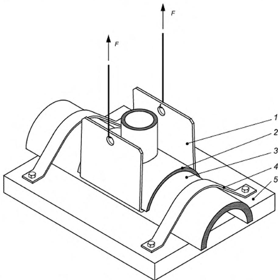
1 — зажимное устройство; 2 — седловой отвод из ПЭ; 3 — труба из ПЭ; 4 — фиксирующий зажим; 5 — опорная плита;
