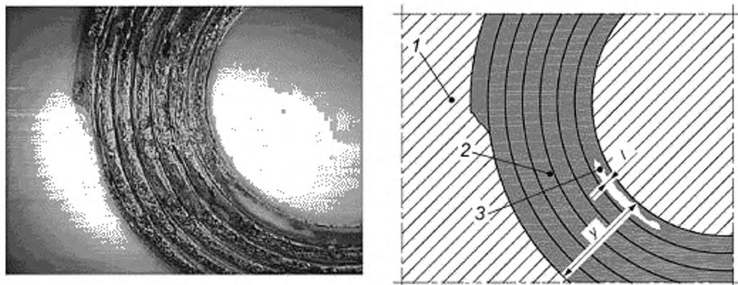
1 – поверхность трубы; 2 – пластическое разрушение; 3 – хрупкое разрушение между витками закладного нагревателя;
