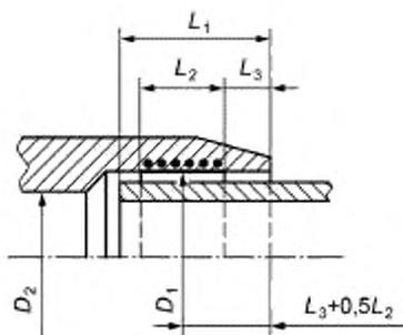
Рисунок 1 — Размеры раструба электросварного фитинга
