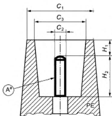
$A$  — рабочая часть;  $C_1$  — наружный диаметр защитной втулки,  $C_1 \geq C_3 \pm 2,0$ ;  $C_2$  — диаметр рабочей части клеммы,  $C_2 \geq 2,0 \pm 0,1$ ;  $C_3$  — внутренний диаметр защитной втулки,  $C_3 \geq C_2 + 4,0$ ;  $H_1$  — расстояние между торцом защитной втулки и рабочей частью клеммы,  $H_1$  должно быть достаточным, чтобы обеспечить степень защиты IP 2X по ГОСТ 14254;  $a$  — высота рабочей части клеммы  $H_2$ , соответствующая  $7,0 \leq H_2$
