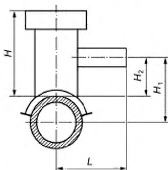
$H$  — высота седлового отвода, то есть расстояние от наружной поверхности трубы до верхней плоскости Т-образного или седлового отвода;  $H_1$  — высота бокового отводного патрубка, то есть расстояние между осью трубы и осью отводного патрубка;  $H_2$  — высота бокового отводного патрубка, то есть расстояние от наружной поверхности трубы до оси отводного патрубка;  $L$  — длина вылета бокового отводного патрубка, то есть расстояние между осью трубы и торцом отводного патрубка
