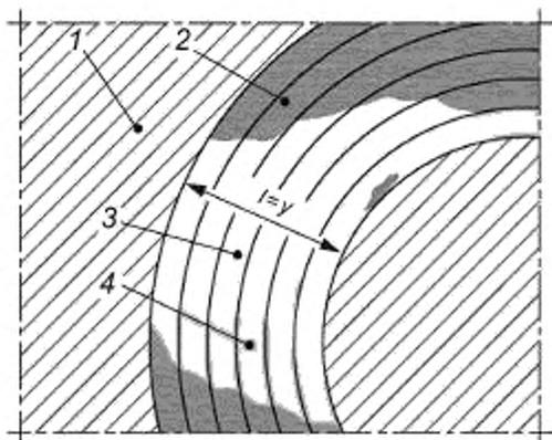
1 — поверхность трубы; 2 — пластическое разрушение; 3 — хрупкое разрушение без адгезии с поверхностью сварки, 4 — хрупкое разрушение между витками закладного нагревателя,  $l$  — максимальная длина хрупкого разрушения,  $y$  — общая длина зоны сварки
