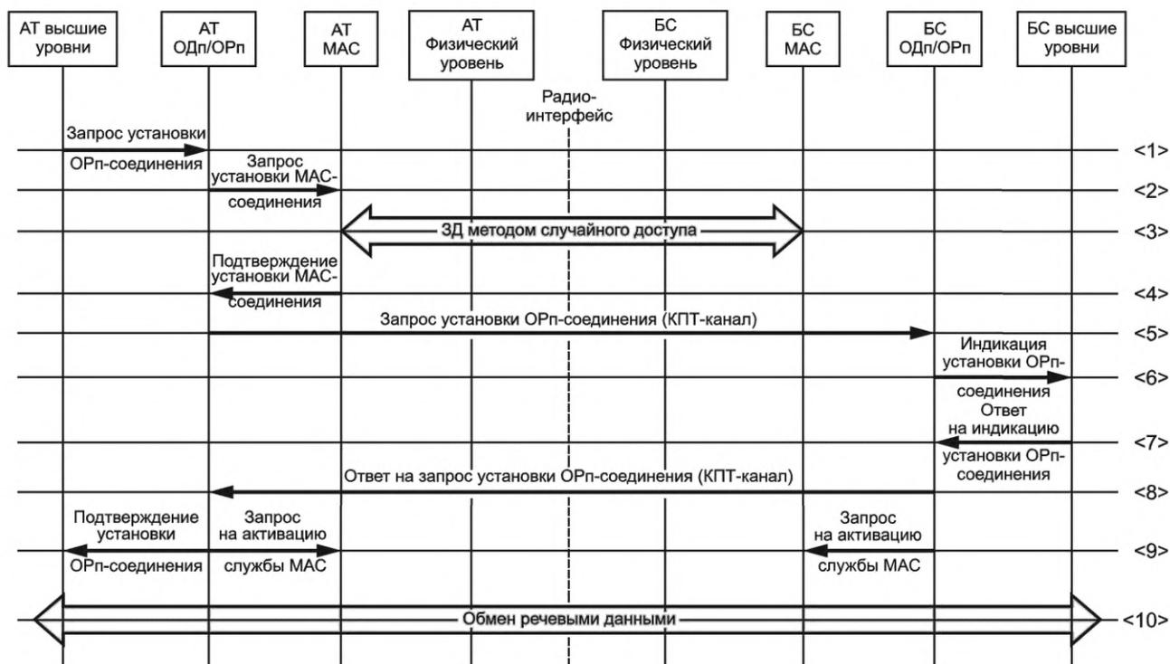
Рисунок 44 — Процедура «Установка соединения ОРп-подуровня по инициативе АТ» при отсутствии соединения с МАС-подуровнем ВС
