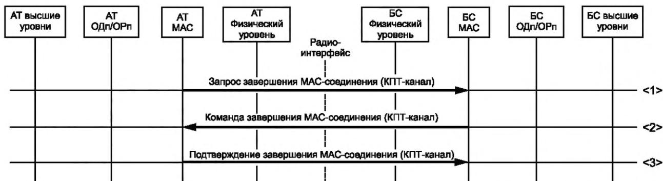
Рисунок 58 — Процедура «Завершение соединения МАС-подуровней по инициативе АТ»
