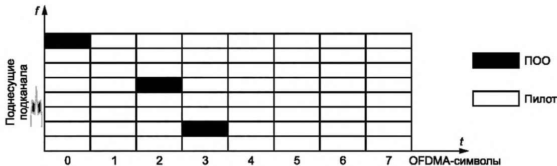
Рисунок 24 — Структура мобильного подканала (ПдК) для обычного тайм-слота
