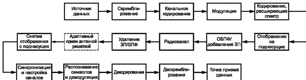
Рисунок 3 — Преобразование потока данных в радиолинии UL
