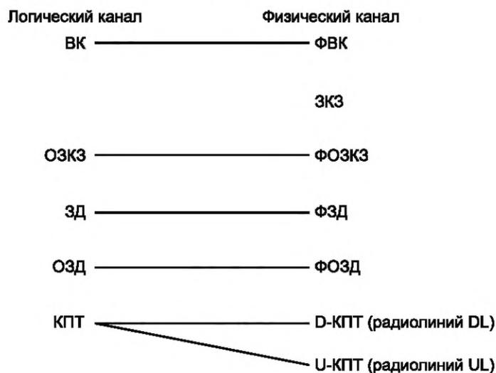
Рисунок 29 — Отображение логических каналов на физические каналы
