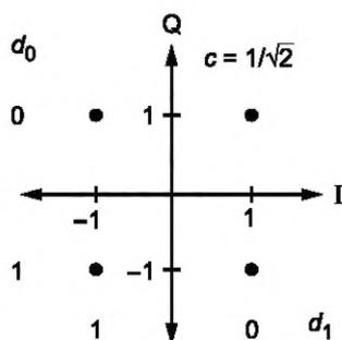
Рисунок 4 — Созвездие QPSK
