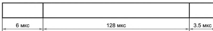
Рисунок 8 — Временная структура OFDMA-символа
