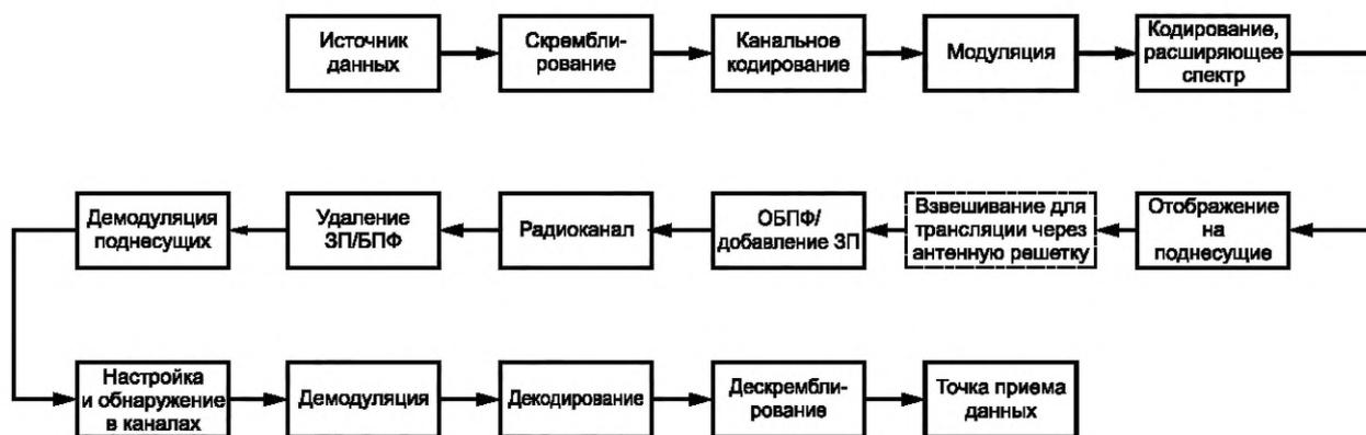
Рисунок 2 — Преобразование потока данных в радиолинии DL
