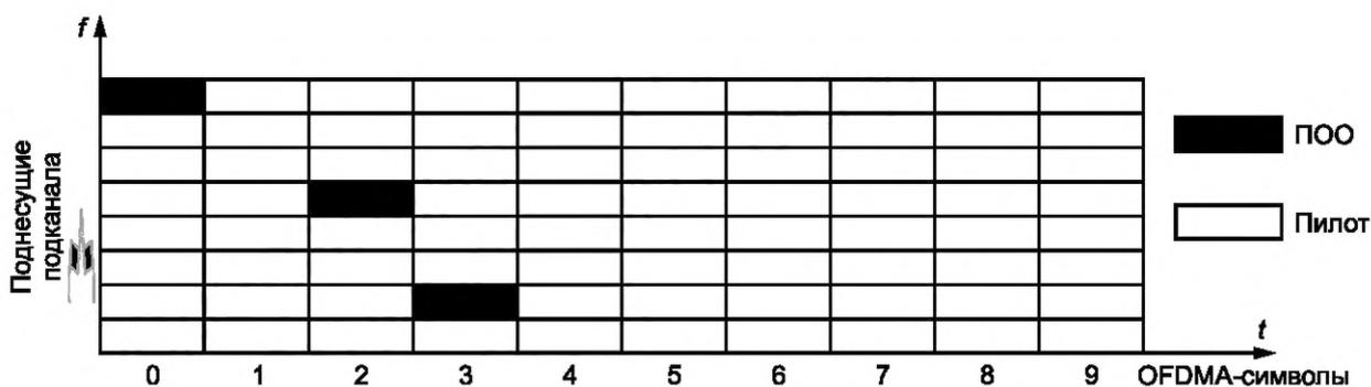
Рисунок 23 — Структура стационарного подканала (ПдК) для супер-тайм-слота
