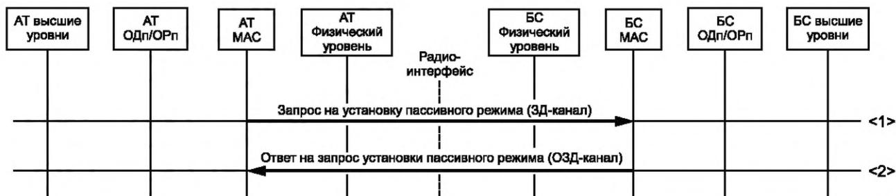
Рисунок 61 — Процедура «Переход в пассивный режим 2»
