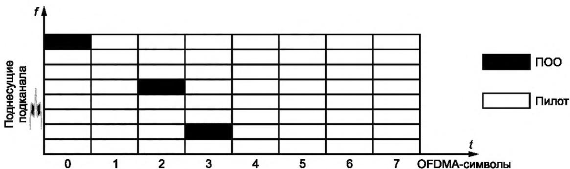
Рисунок 22 — Структура стационарного подканала (ПдК) для обычного тайм-слота
