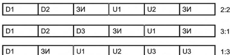
Рисунок 19 — Распределение тайм-слотов в радиолиниях DL/UL для кадра длительностью 5 мс
