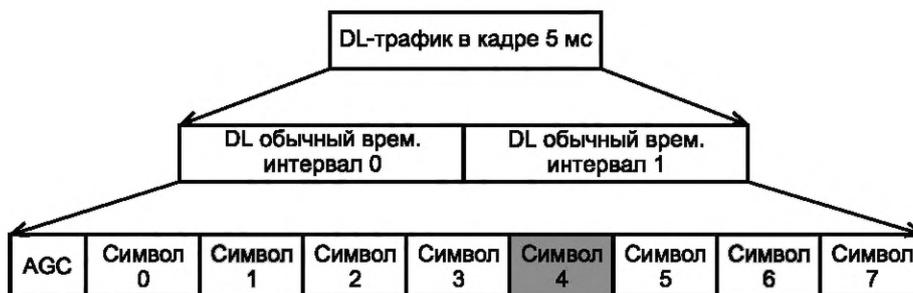
Рисунок 16 — Структура тайм-слотов в кадре трафика в DL длительностью 5 мс
