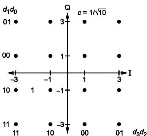
Рисунок 6 — Созвездие 16QAM
