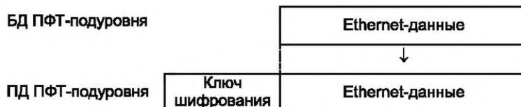
Рисунок 38 — Формирование ПД ПФТ-подуровня из Ethernet-данных (режим с шифрованием)
