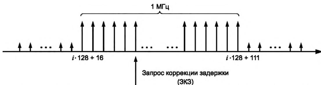
Рисунок 11 — Спектральная структура множества поднесущих, составляющих ЗКЗ-сигнал
