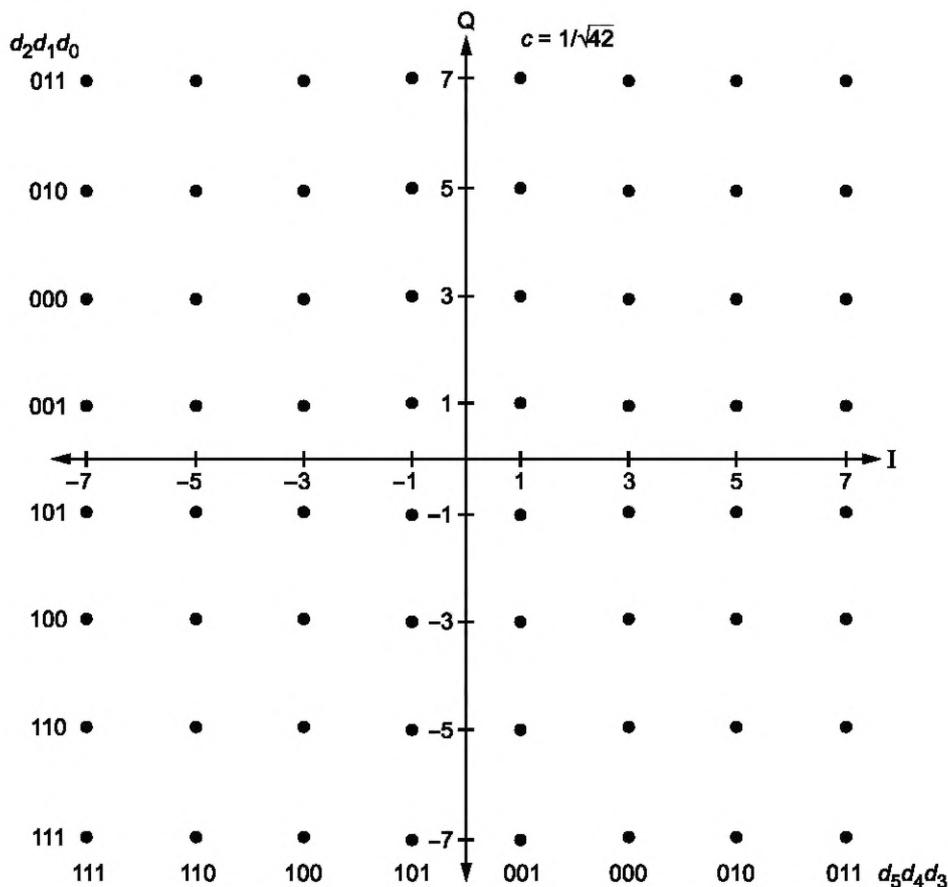
Рисунок 7 — Созвездие 64QAM
