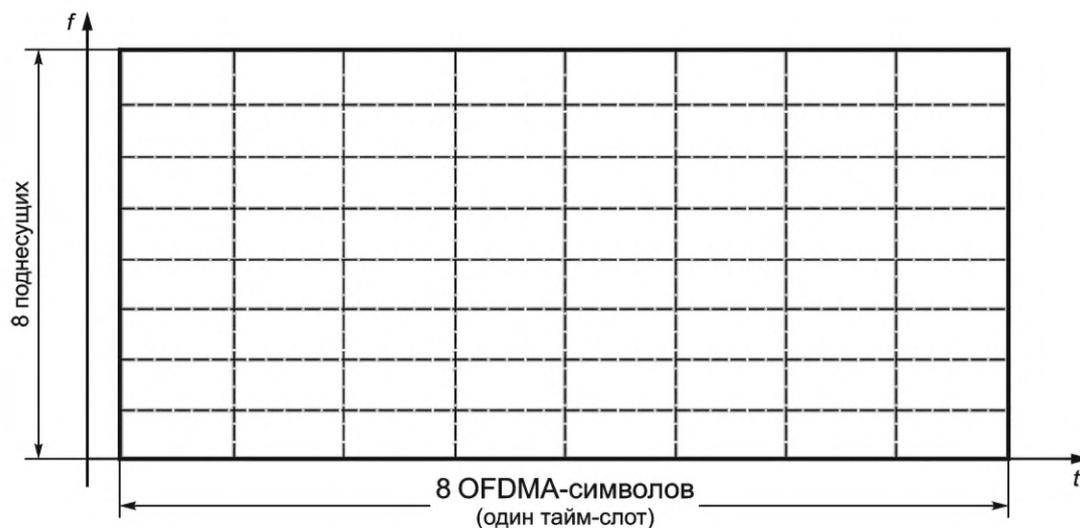
Рисунок 20 — Структура подканала (ГДК) в обычном тайм-слоте
