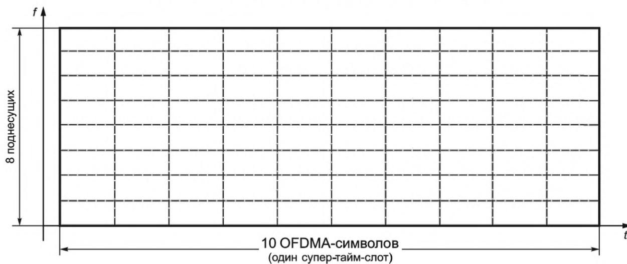
Рисунок 21 — Структура подканала (ГДК) в супер-тайм-слоте
