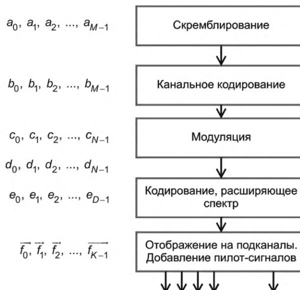
Рисунок 1 — Диаграмма преобразования потока информации на физическом уровне
