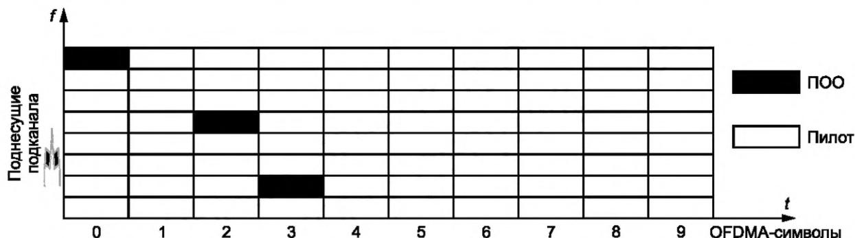
Рисунок 25 — Структура мобильного подканала (ПдК) для супер-тайм-слота
