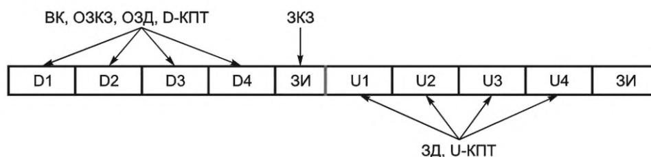
Рисунок 26 — Размещение физических каналов на временных интервалах кадра
