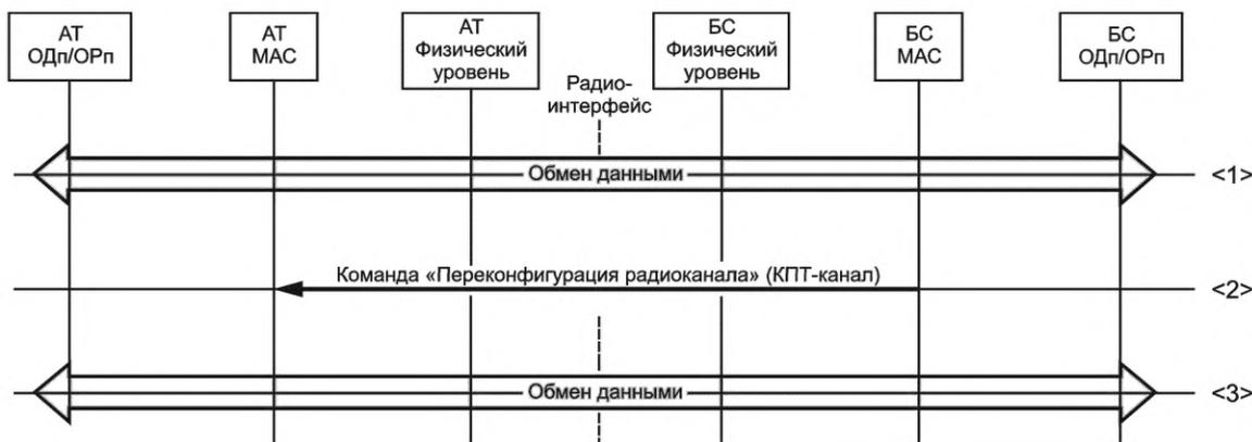
Рисунок 53 — Процедура «Переконфигурация (изменения полосы) радиоканала», осуществляемая БС
