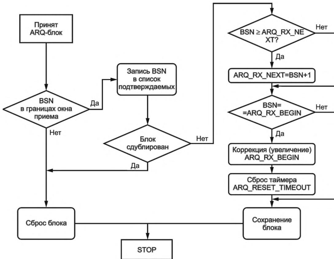
Рисунок 32 — Алгоритм работы в режиме ARQ
