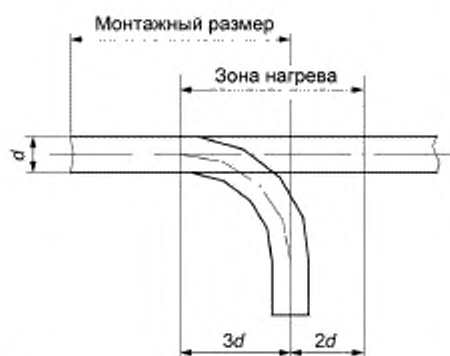
Рисунок 1 — Зона нагрева трубы для выполнения гибки под углом 90^\circ
