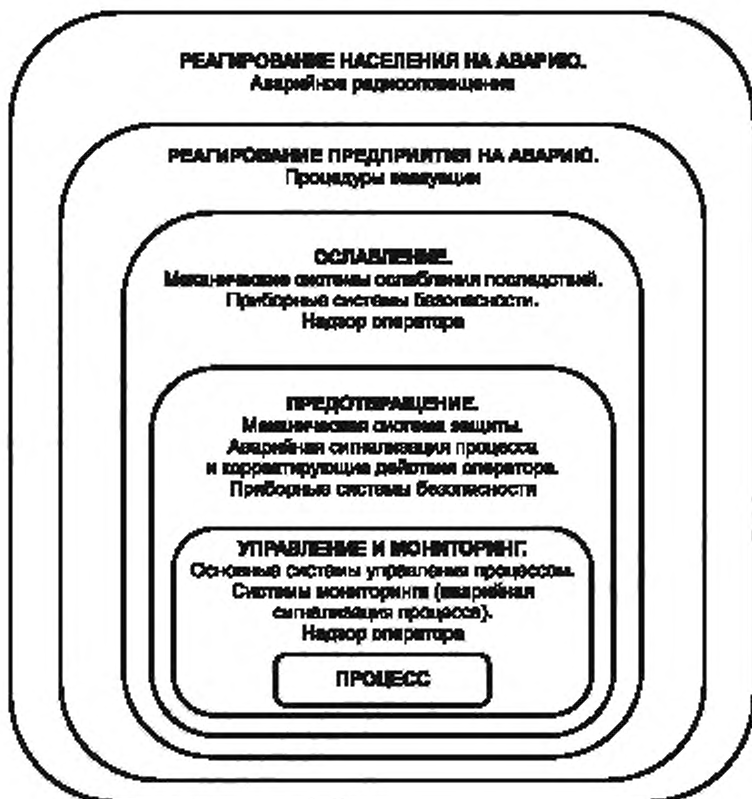
Рисунок 9 — Типовые слои защиты и средства снижения риска
