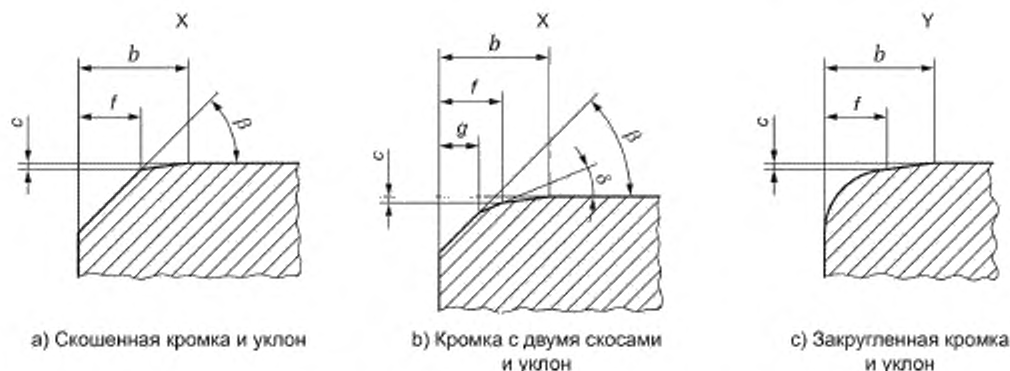
Рисунок 12 — Варианты уступа (выносные элементы X и Y рисунка б)
