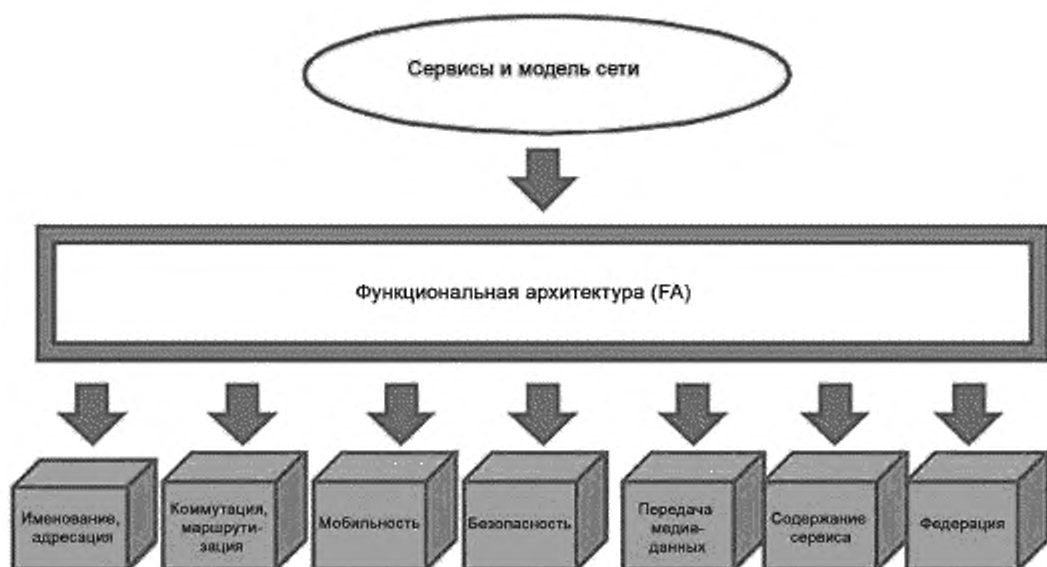
Рисунок 4 — Компоненты конструктивных элементов (ВВ) для архитектуры Будущих сетей
