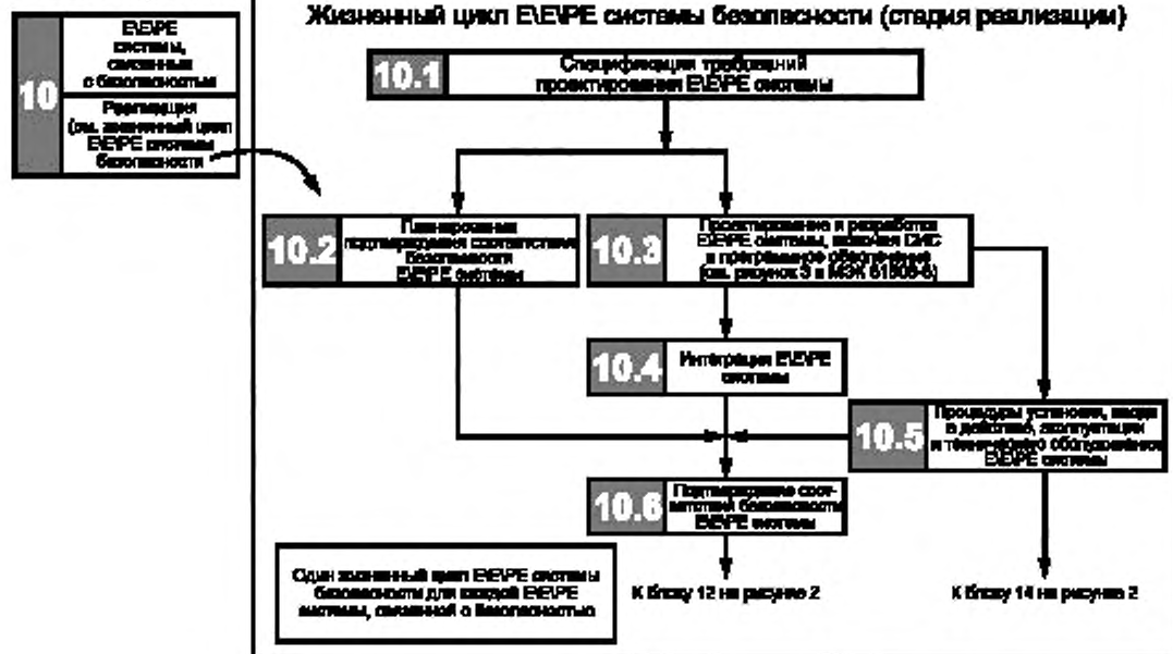
Рисунок 3 — Структура жизненного цикла E/E/PE системы безопасности (стадия реализации)
