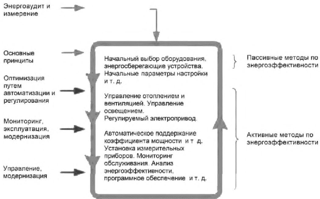
Рисунок 3 — Повторяющийся процесс управления энергоэффективностью
