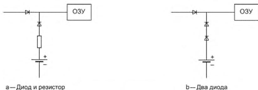
Рисунок 8 — Примеры цепей безопасности для защиты от заряда
