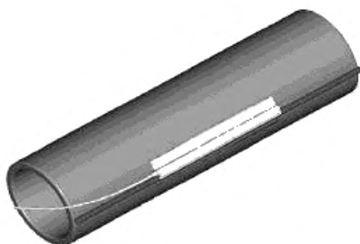
Рисунок 6 — Датчик ограничителя температуры на оболочке электронагревателя
