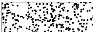
Рисунок А.9 — Пористость 16 %, 244 поры, d = 1 мм
