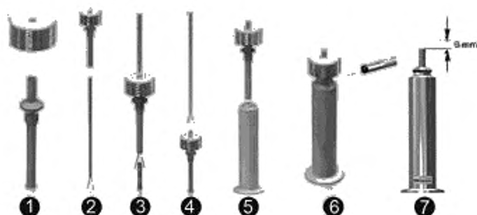
Рисунок 5 — Пошаговая установка фитиля
