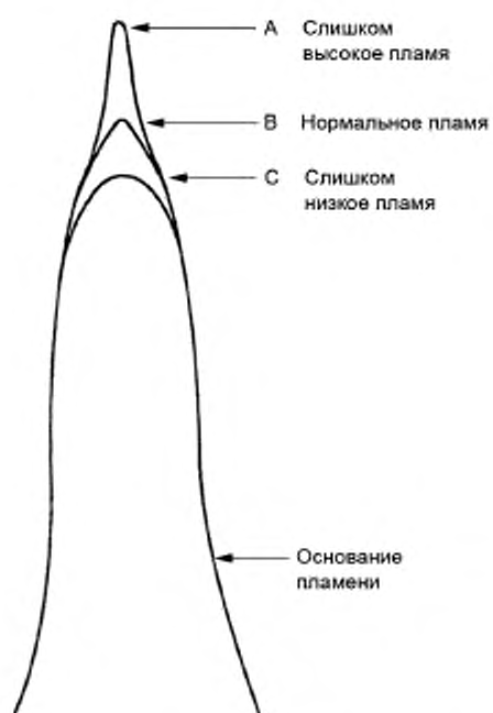
Рисунок 6 — Типовые формы пламени
