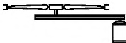
d — привод с ортогональной зубчатой передачей, с опорой вентилятора
