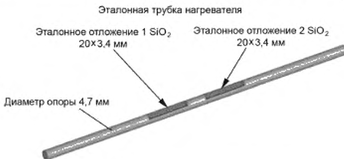
Рисунок A.2.2 — Эталонная нагревательная трубка
