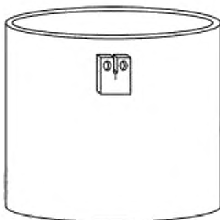
Рисунок 6 — Испытательный образец: тип и положение
