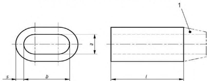
б) Цилиндрическое кольцо типа С с коническим концом
