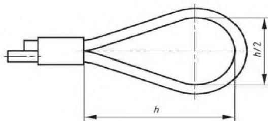
Рисунок 3 – Пример петли с обратным хвостом
