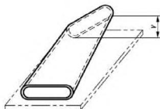
Рисунок А.3 – Скручивание трубы
