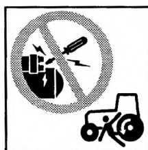
Рисунок D.28 – Пример символического изображения с использованием графического элемента красного цвета в виде круга, перечеркнутого наклонным отрезком прямой, для обозначения запрещенного действия
