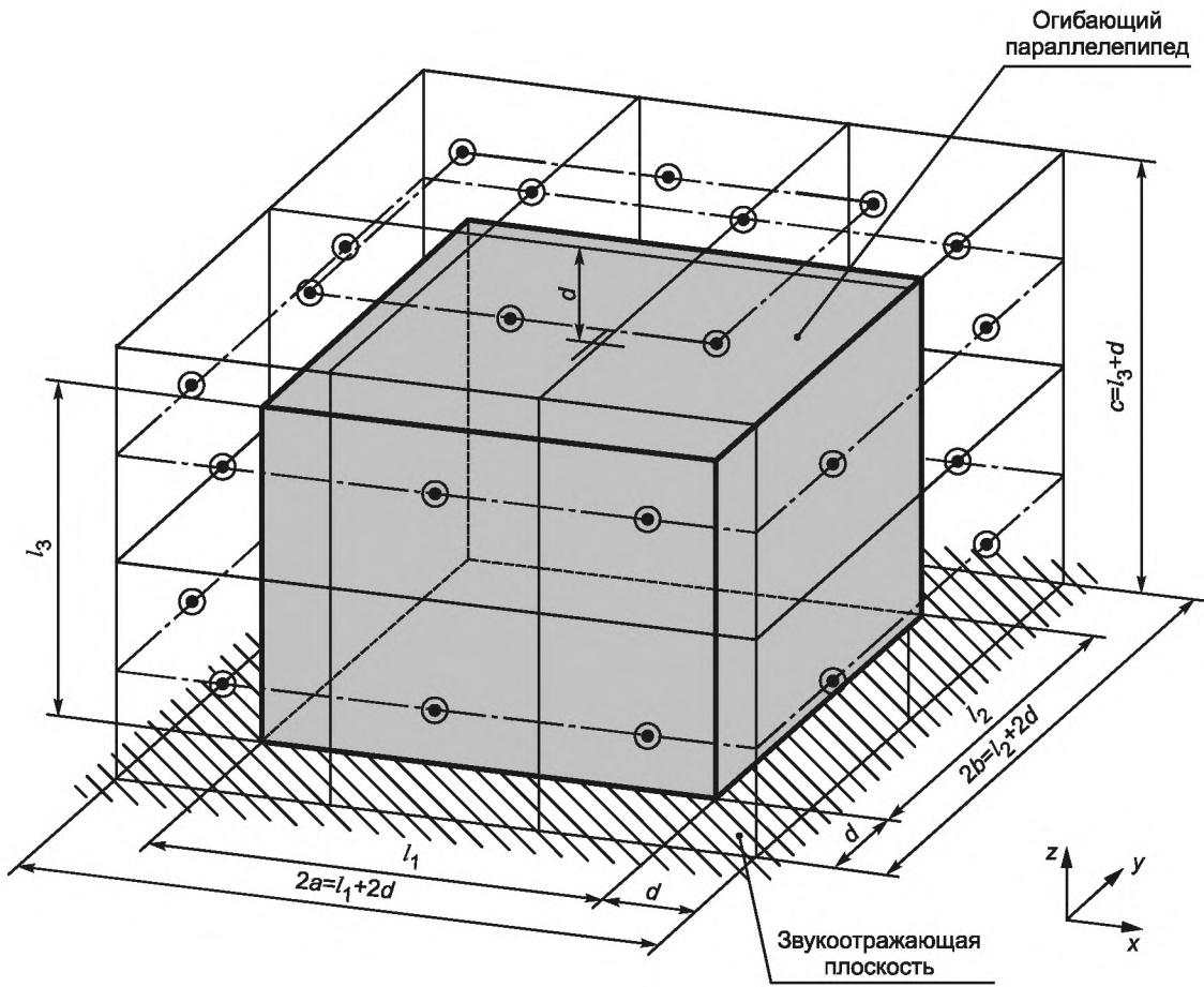
Рисунок В.6 — Пример измерительной поверхности и точек измерения на ней для больших машин
