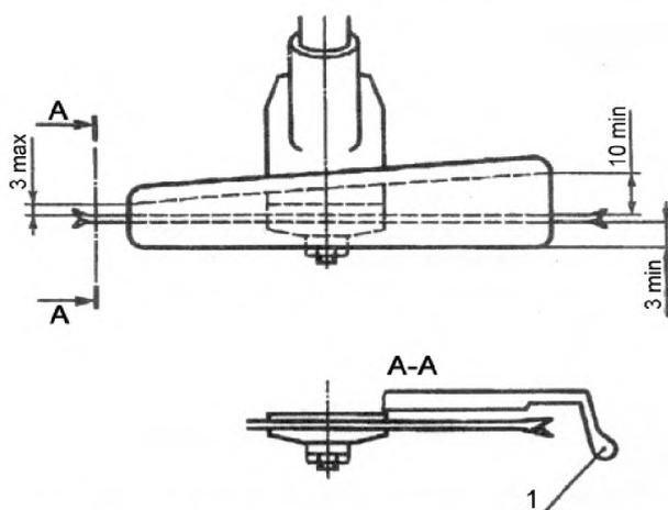
1 – скругленная кромка для предотвращения зацепления
