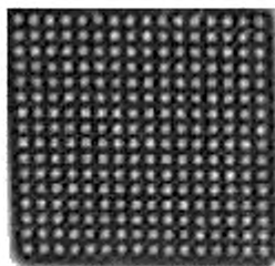
Рисунок E.10 — Корпус BGA до разделения
