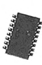
Рисунок E.9a — Корпус ИМС с выводной рамкой
