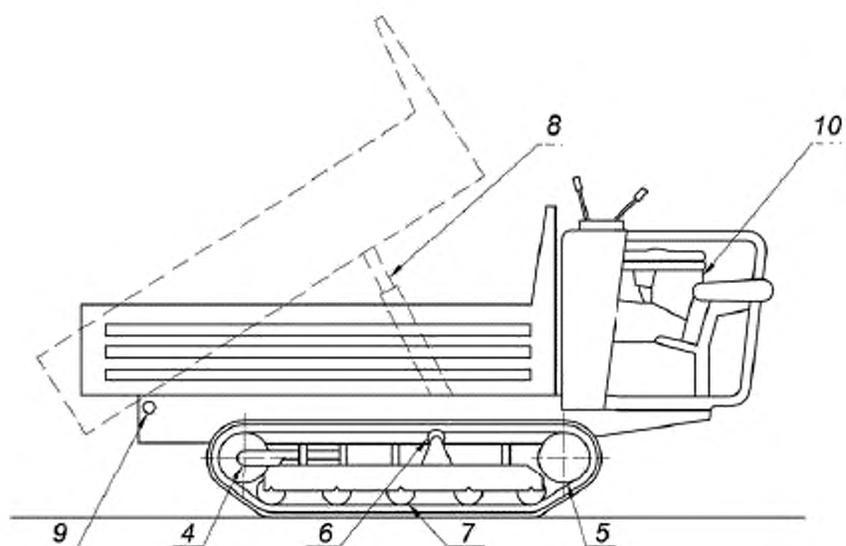
1 — гусеница; 2 — основная рама; 3 — кузов; 4 — ленивец; 5 — приводная звездочка; 6 — поддерживающий ролик;
