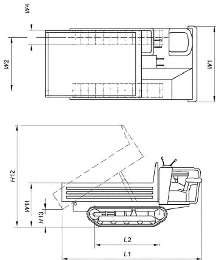
Рисунок 29 — Размеры гусеничного мини-самосвала. Рабочее место оператора сзади
