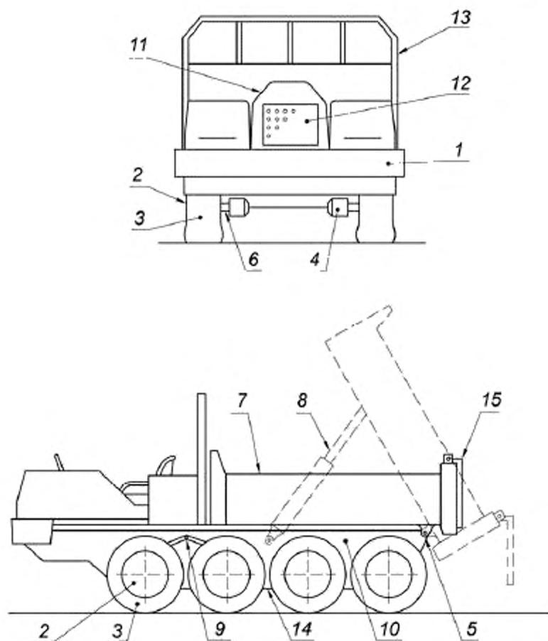
1 — крыло; 2 — колесо; 3 — шина; 4 — тормозная система; 5 — ось и корпус шарнира; 6 — ось; 7 — кузов; 8 — гидроцилиндр; 9 — трансмиссия; 10 — основная рама; 11 — калот; 12 — энергетическая установка; 13 — ограждение; 14 — кожух, цепной привод; 15 — задний откидной борт
