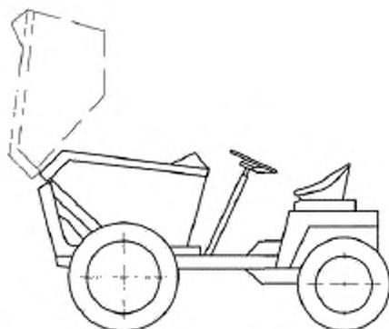
Рисунок 6 — Разгрузка с предварительным подъемом кузова
