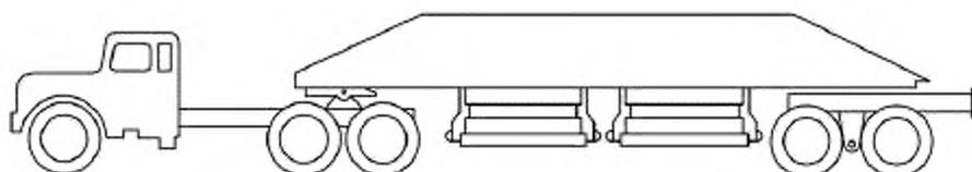
Рисунок 20 — Самосвальный полуприцеп с числом осей более трех
