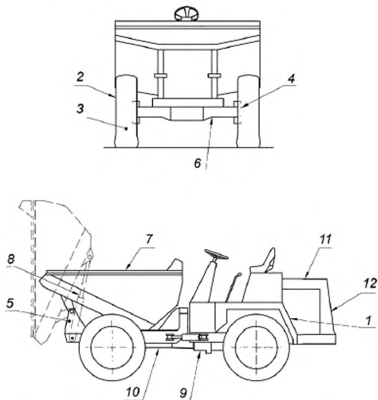
1 — крыло; 2 — колесо; 3 — шина; 4 — тормозная система; 5 — ось и корпус шарнира; 6 — ось (оси); 7 — кузов;
