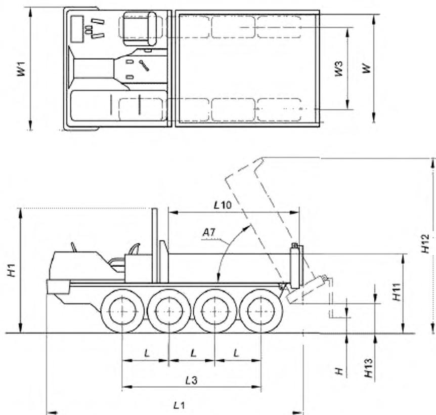
Рисунок 28 — Размеры восьмиколесного мини-самосвала
