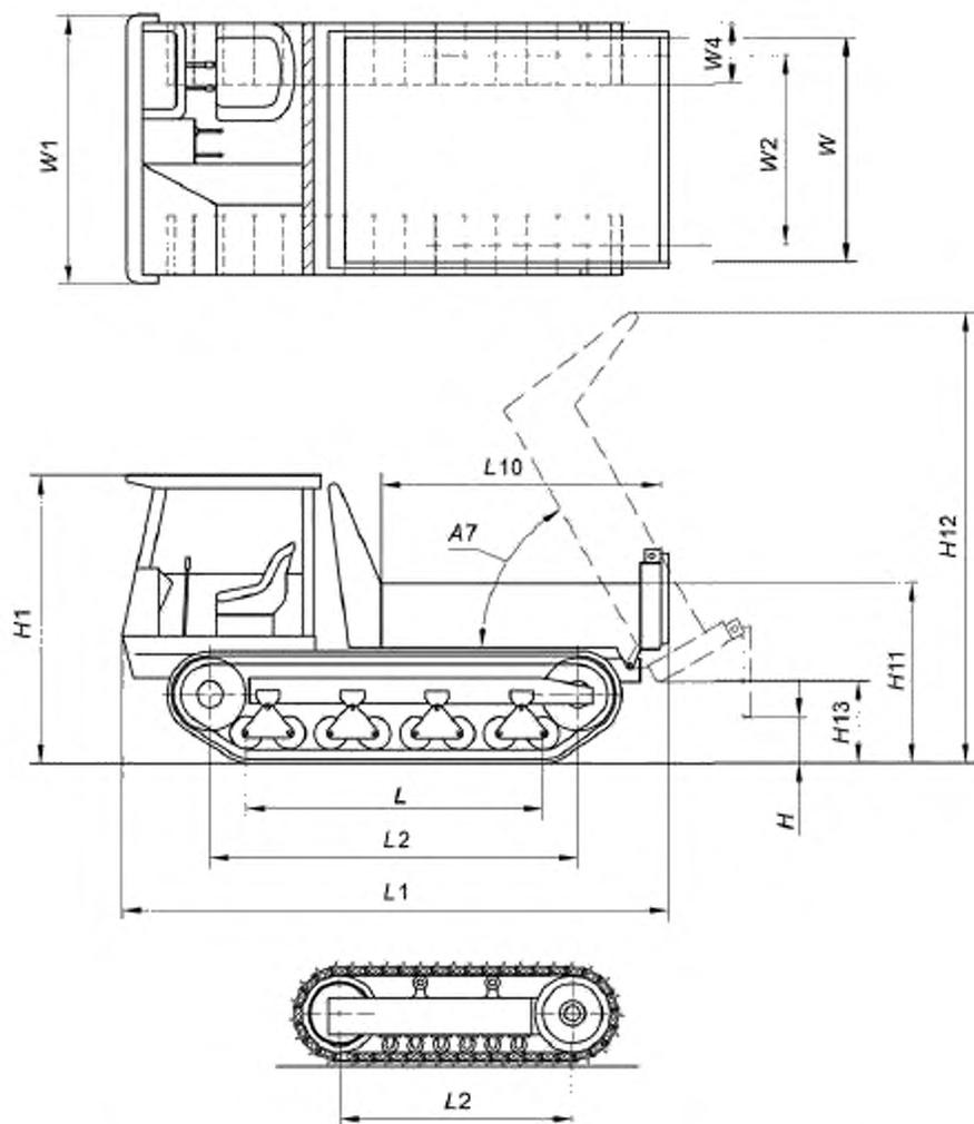
Рисунок 30 — Размеры гусеничного мини-самосвала. Рабочее место оператора спереди
