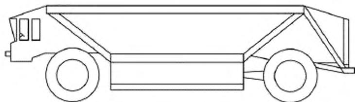
Рисунок 2 — Донная разгрузка
