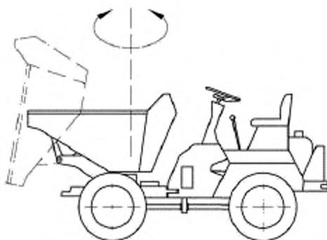
Рисунок 5 — Поворотная разгрузка
