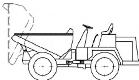
Рисунок 4 — Передняя разгрузка
