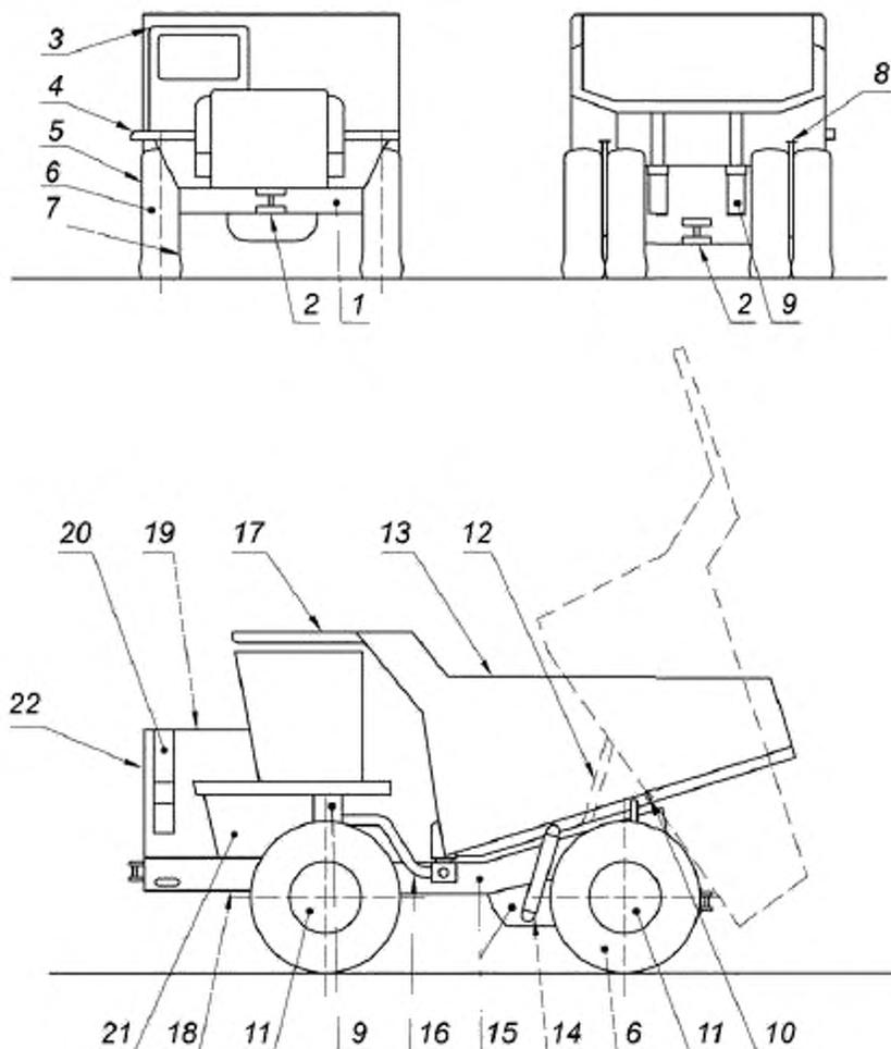
1 — бампер; 2 — цапфа буксирного устройства; 3 — кабина; 4 — крыло; 5 — колесо; 6 — шина; 7 — тормозное устройство;
