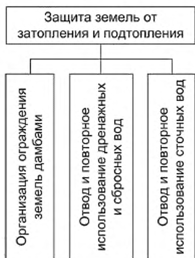
Рисунок А.8 — Классификация по типам мелиоративных мероприятий «Защита земель от затопления и подтопления»
