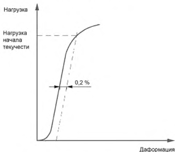
Рисунок В.3 — Определение нагрузки начала текучести
