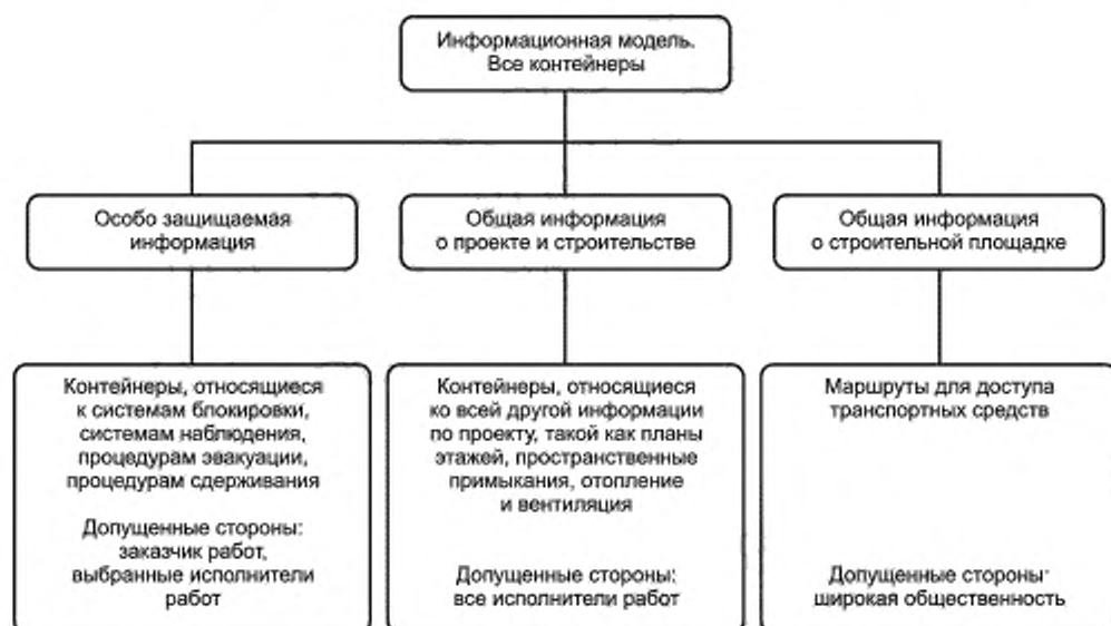
Рисунок А.4 — Пример структуры разбиения контейнера для обеспечения информационной безопасности
