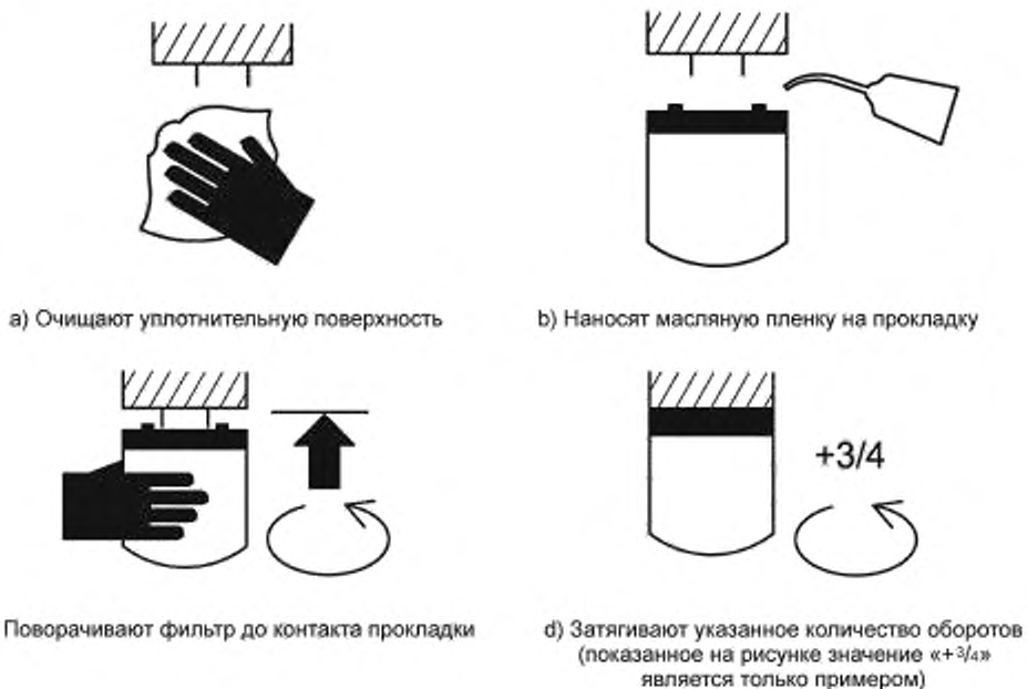
Рисунок 6 — Установка и последовательность закручивания фильтра
