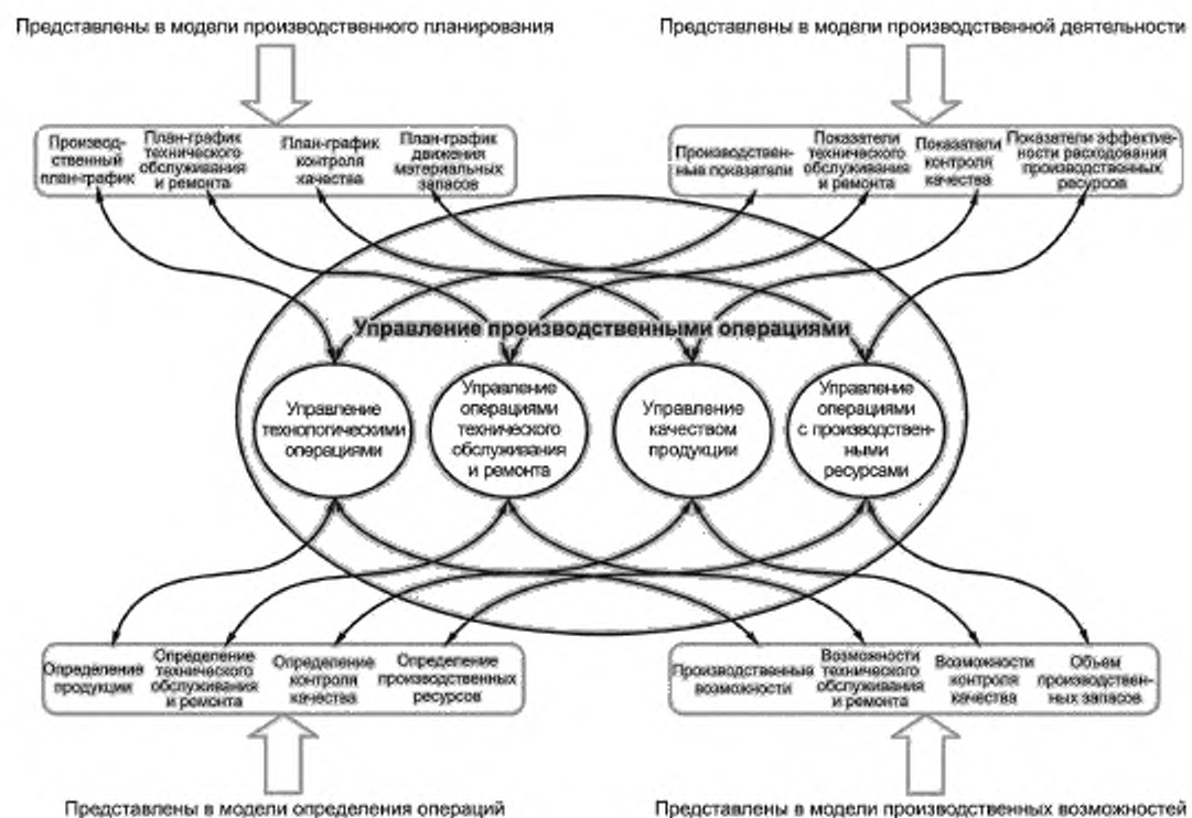
Рисунок А.5 — Информационная модель операций для управления производством (МЭК 62264-3)
