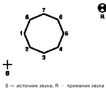
Рисунок 25 — Плоская поверхность с однородными акустическими свойствами и здание призматической формы, приемник на большой высоте
