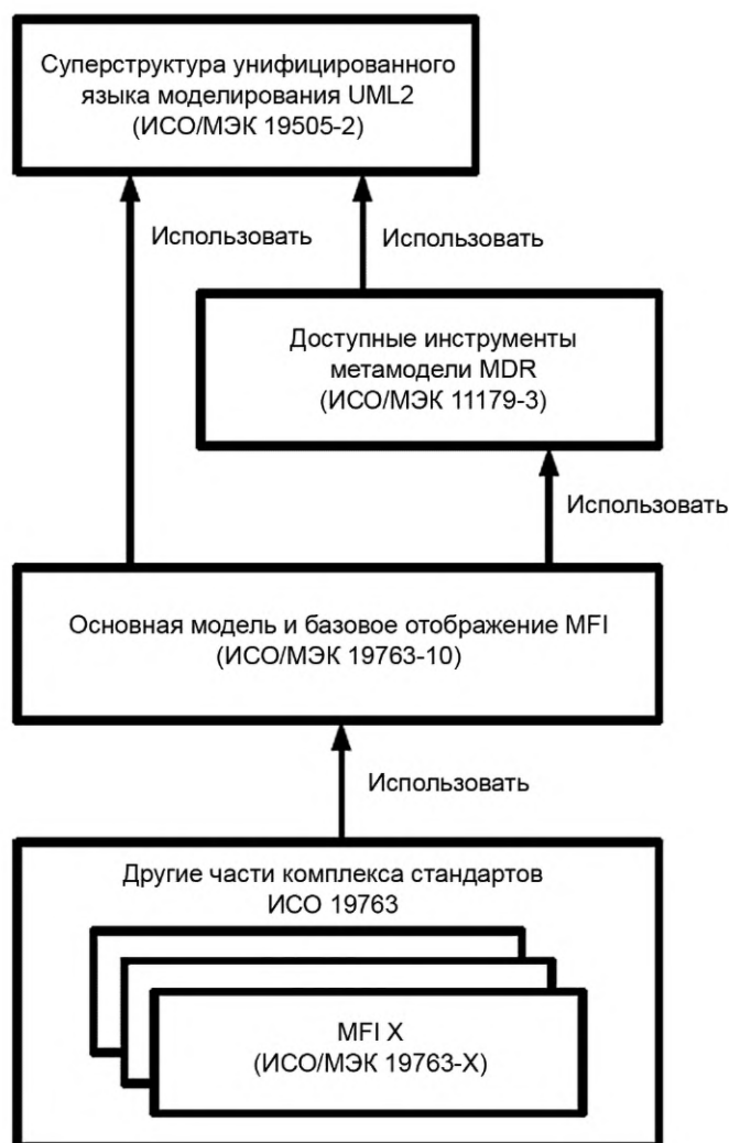
Рисунок 9 — Общая структура стандартов MFI и их соотношение со стандартами MDR и языком моделирования UML
