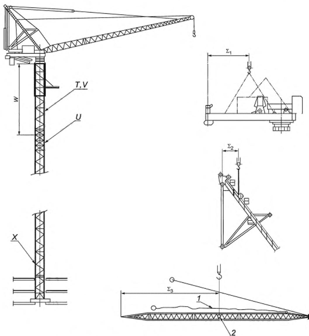
1 — оттяжка при монтаже; 2 — центр тяжести;  $T$  — число секции башни (стандартное),  $U$  — число усиленных секций башни;  $V$  — полные размеры и масса секции башни;  $W$  — максимальный выступ выше несущей балки;  $X$  — данные внутренней подъемной секции и ее масса,  $\Sigma_1, \Sigma_2, \Sigma_3$  — примеры списка масс компонентов и расположения центров тяжести для целей транспортирования и монтажа
