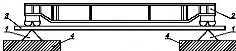
1 — опорные призмы, 2 — крановый компонент; 3 — платформа, 4 — динамометры сжатия
