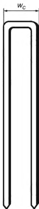
Рисунок А.18 — Схематическое изображение измерения размера свода скобы
