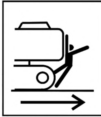
Рисунок Г.21 — Пример использования стрелки для отображения направления движения машины в целом
