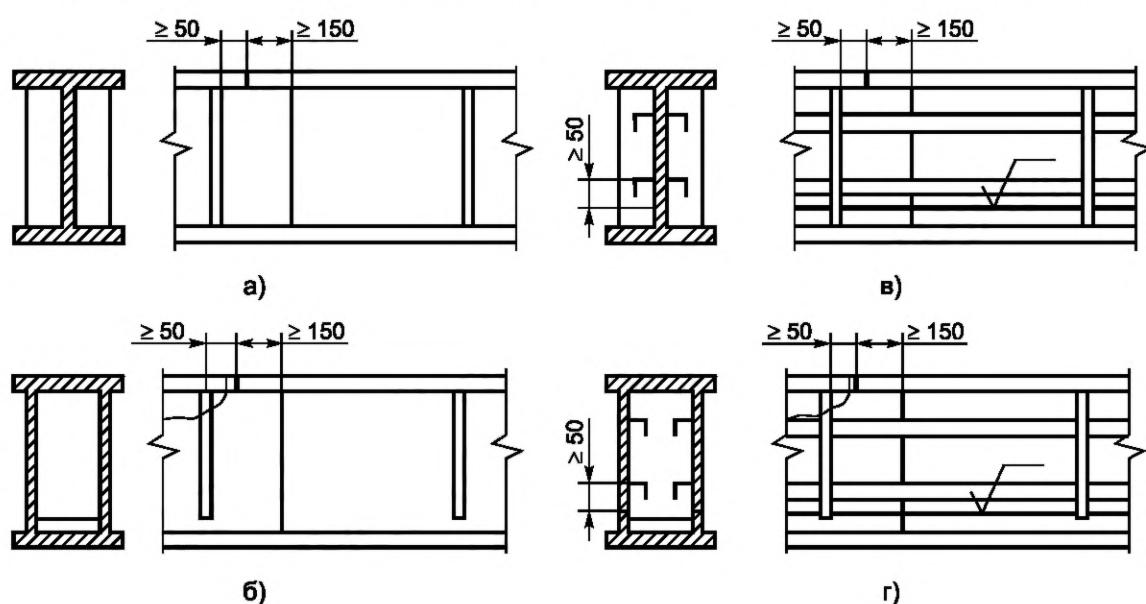
Рисунок 1 — Расположение сварных стыков в металлических конструкциях
