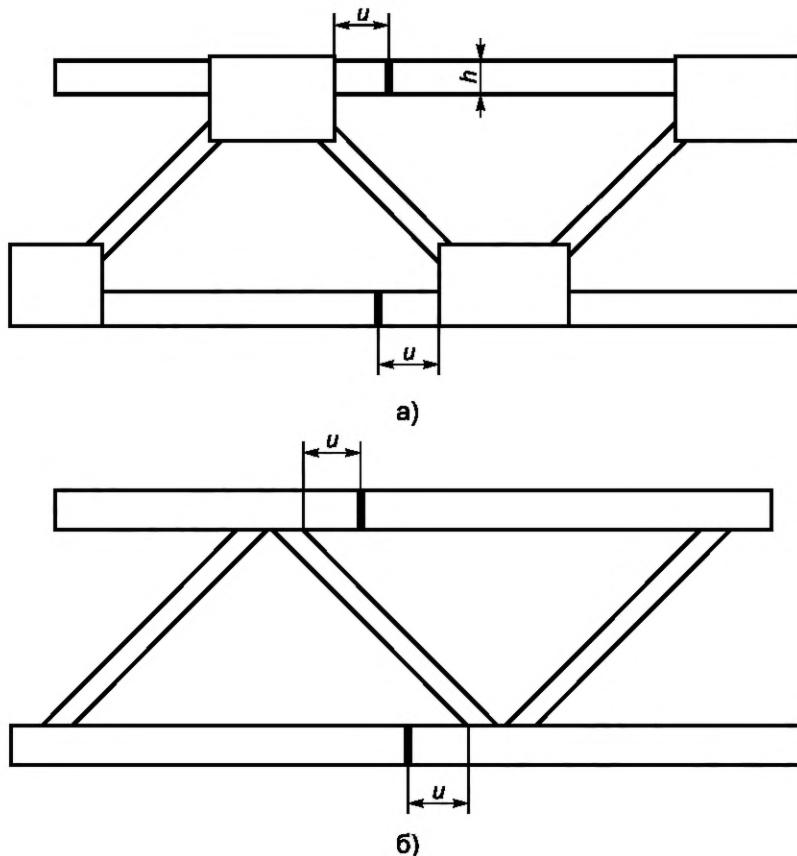
Рисунок 2 — Расположение сварных стыков в решетчатых металлических конструкциях с узлами на косынках (а) и с непосредственным примыканием стержней (б)
