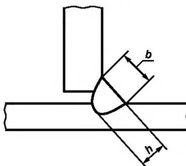
Рисунок 3 — К определению величины коэффициента формы шва  $b/h$
