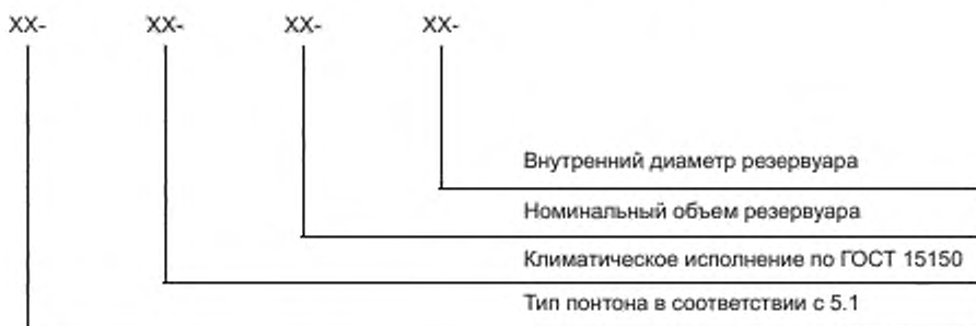
Рисунок 1 — Схема условного обозначения понтона
