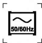
Рисунок 2 — СД-лампа, предназначенная для работы на частоте 50 или 60 Гц
