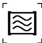
Рисунок 1 — СД-лампа, предназначенная для работы на высокой частоте
