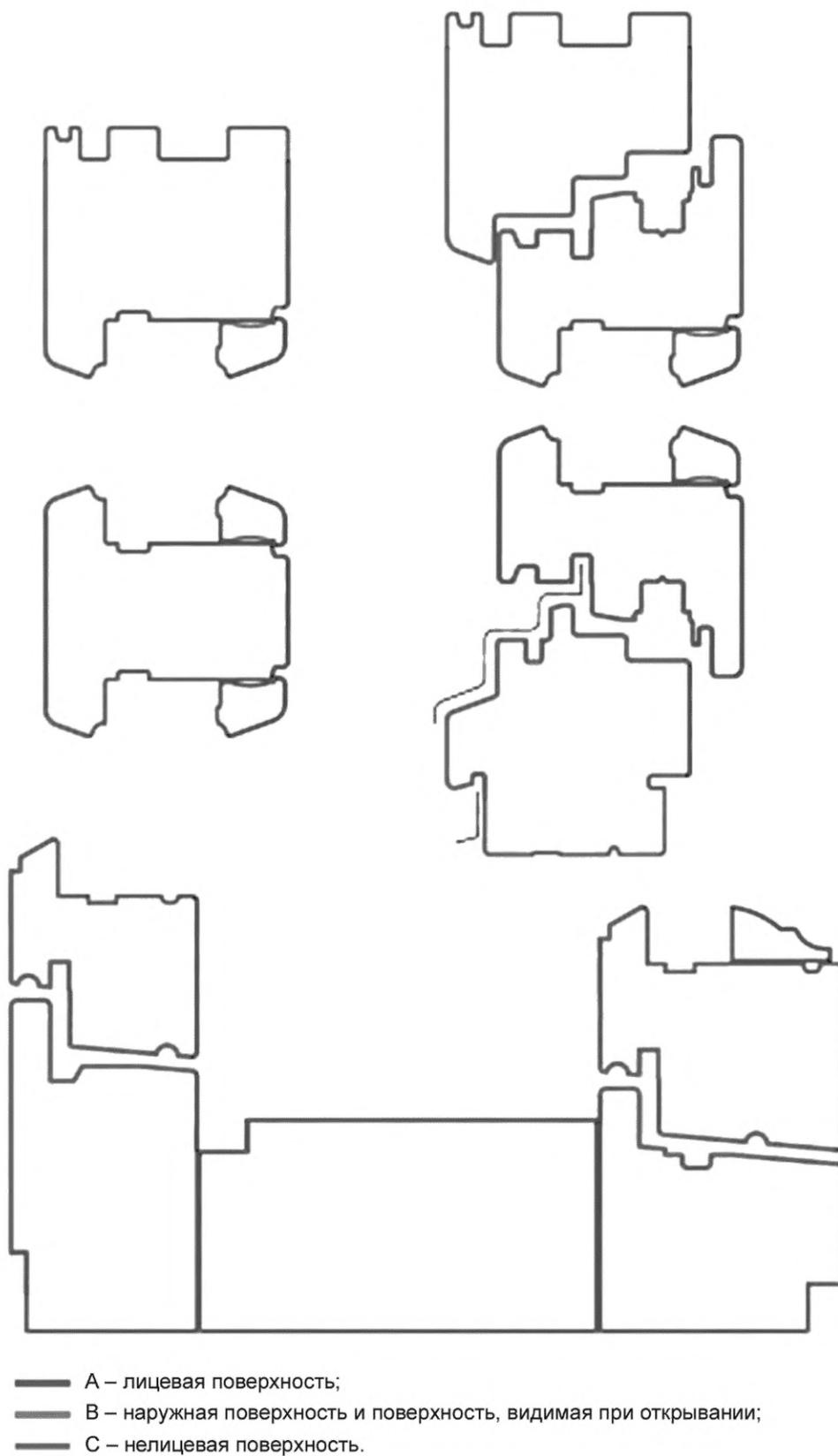
Рисунок 9 — Примеры определения видов поверхностей деталей
