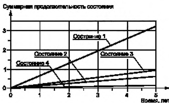
Рисунок 18 — График зависимости от времени Ast_i(t_1, t_2) для марковской модели, представленной на рисунке 15
