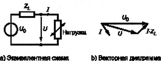
Рисунок 5 — Схема замещения и векторная диаграмма для простых оценок
