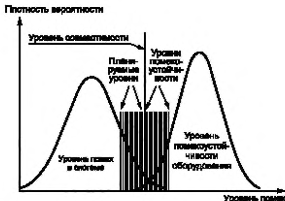
Рисунок 1 — Иллюстрация основных концепций качества напряжения со статистикой «время/расположение» применительно к системе в целом
