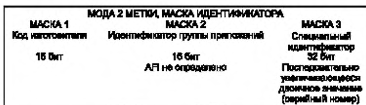
Рисунок 9 — Логическая организация идентификатора радиочастотной метки
